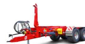
THL 20 (20-24 ton totaalgewicht), 17-21 ton optrekkracht)
