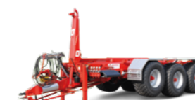
THL 30 (31 - 34 ton totaalgewicht, 30 ton optrekkracht)
